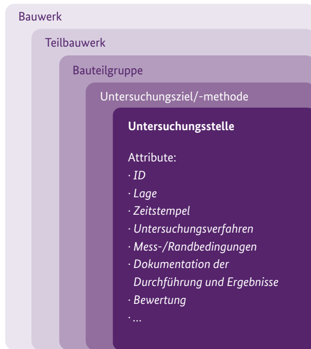
ABB 7.4 Schematische Darstellung der Hierarchieebenen von Diagnostikdaten in Digitalen Zwillingen
