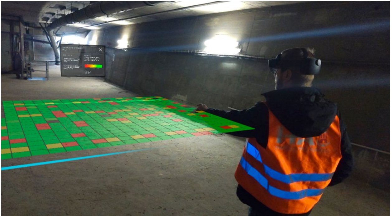
ABB 10.5 Blick durch die AR-Brille und lagegerechte Visualisierung der Informationen aus dem Digitalen Zwilling (Foto: customQuake)
